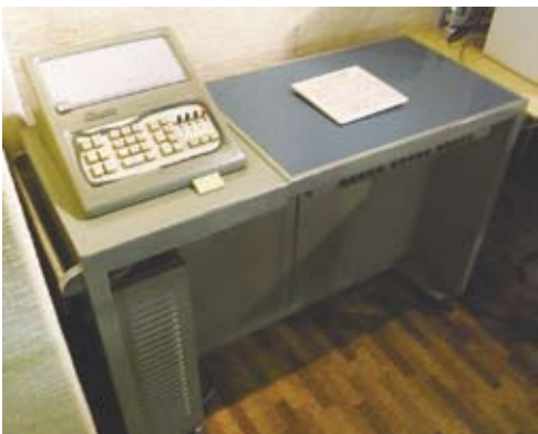
昭和32年に登場した、国産初の純電気式計算機「カシオリレー式計算機」。
